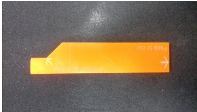
Figura 6 Escuadra para nivel cabezal. Se debe apoyar en el motor (flecha izquierda) y en el material que se va a cortar (flecha derecha).
