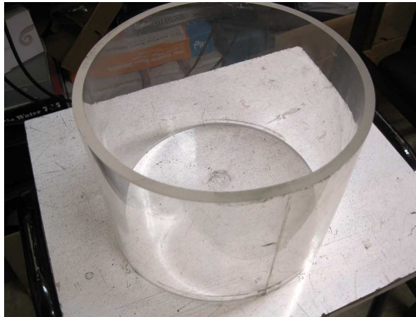
Figura 4.4. Contenedor de acrílico. Se aprecia la costura de unión de los extremos de la placa usada para moldear este contenedor.
