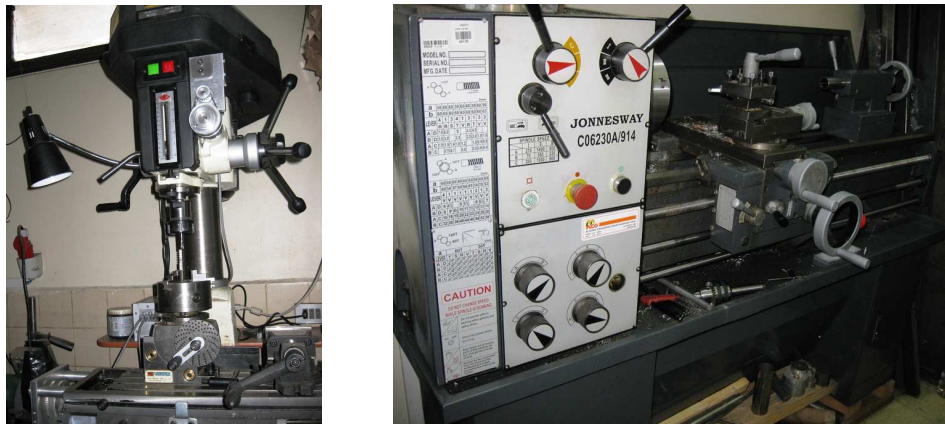
Figura 4.1. Izquierda: Fresadora ARFA. Derecha: Torno JONNESWAY. Todas las piezas del montaje experimental se fabricaron con estas máquinas.
