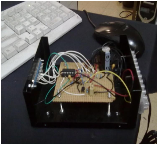
Figura 4.10.- Interfaz donde son conectados los termistores.
