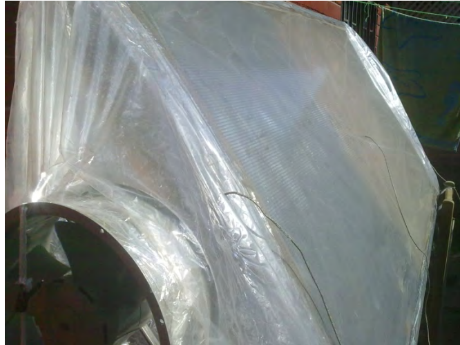
Figura 36: colector instalado con la mitad de densidad absorbente.
