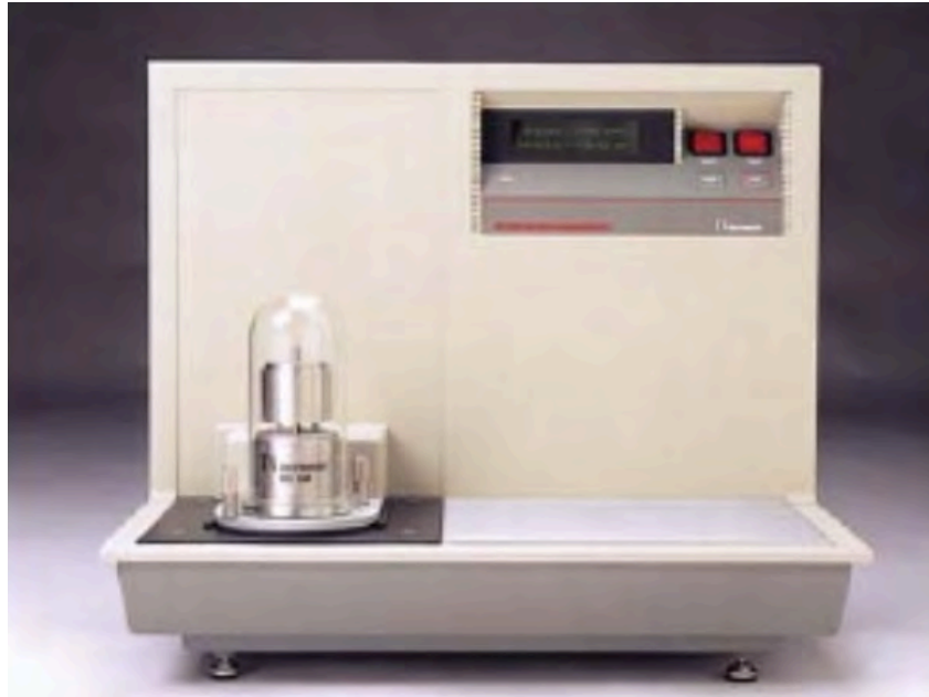
Figura 9. Equipo DSC 2920 modulated DSC [28].
