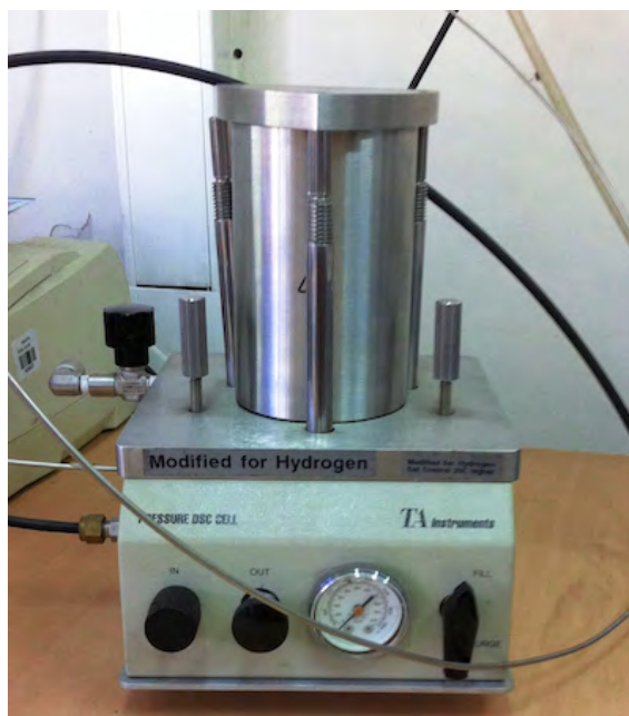
Figura 11. Celda de Presión modificada para Hidrógeno.
