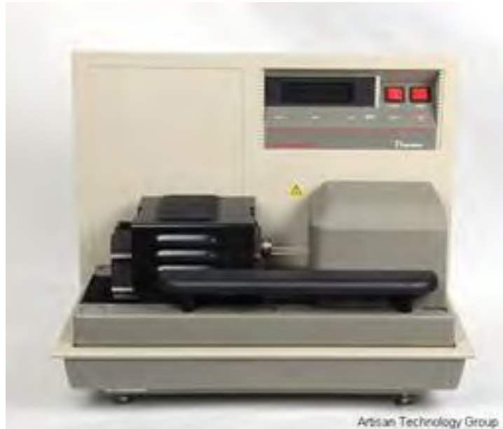
Figura 13. Equipo SDT Simultaneous DSC-TGA [32].
