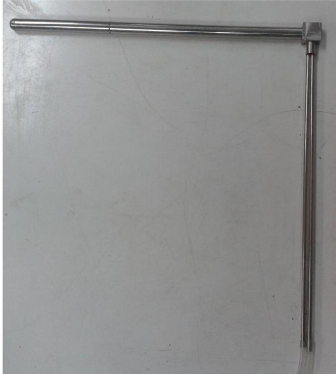
Figura (22): imagen del tubo de Pitot de cabeza semi-esférica construido en el laboratorio.
