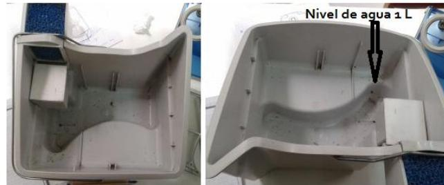
Figura 3.5: Estanque de agua. Tiene indicado el nivel de agua necesaria para el filtrado de polvo.
