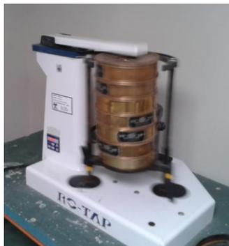
Figura 4.20: Tamizador Tyler modelo RX-29-10 en funcionamiento.
