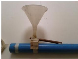
Figura 4.10: Unión de embudo con tubo de cobre para el depósito de material en tubo de PVC.
