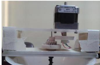
Figura 4.9: Caja de acrílico y soportes de madera en cuyo interior se encuentra el sistema de engranajes.
