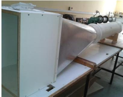
Figura 4.14: Tubo de PVC conectado a la pieza de transformación metálica.
