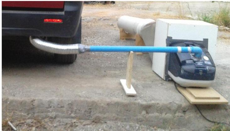
Figura 5.2: Unión entre tubo de escape de camioneta y tubo de ingreso de la aspiradora.
