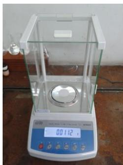
Figura 4.21: Balanza RADWAG AS 220/C/2 utilizada en medición de masa de filtros.
