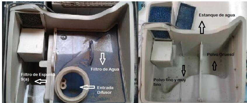
Figura 3.17: a) Se indica Filtro de agua (9) y Filtro de espuma (9a). b) Se indica la separación de material dentro del estanque de agua (10).
