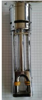
Figura 3.24: Psicrómetro utilizado en las mediciones.
