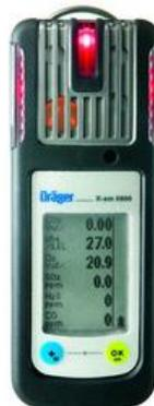
Figura 5.3: Analizador de Gases Dräger x-am 5600 utilizado en la medición.
