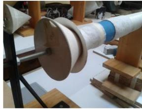
Figura 3.31: Cono estrangulador utilizado para la variación del caudal.
