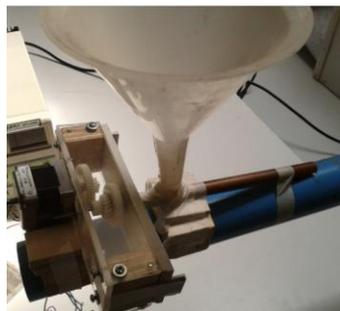
Figura 4.11: Tolva de alimentación de material particulado utilizado en el experimento.
