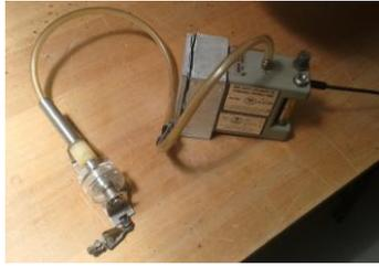
Figura 4.15: Bomba utilizada en la medición del sistema de Filtrado de Polvo
