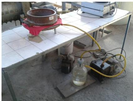
Figura 4.22: Bomba de succión de agua.
