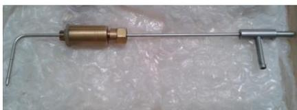
Figura 3.27: Tubo de Pitot de 3 [mm] utilizado en el trabajo.
