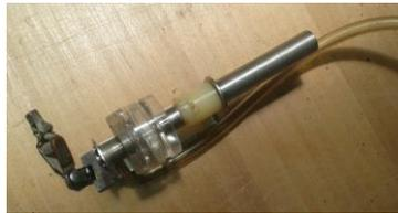
Figura 4.16: Estructura por donde ingresa el aire succionado.
