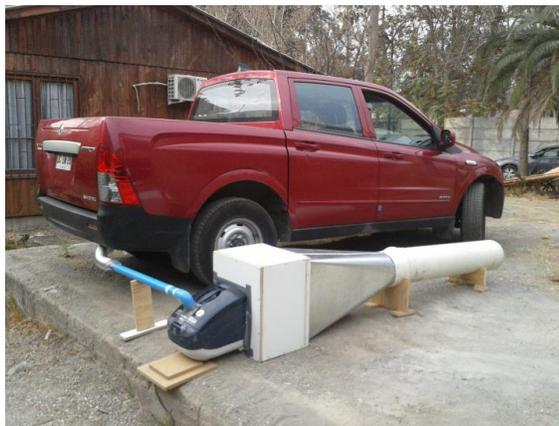
Figura 5.1: Montaje Experimental utilizado para la medición del filtrado de gases.
