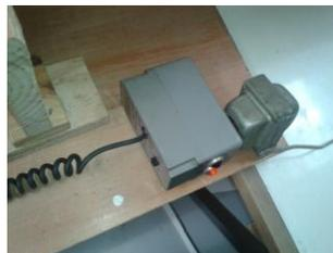
Figura 4.17: Transformador y dispositivo de encendido de la Bomba.
