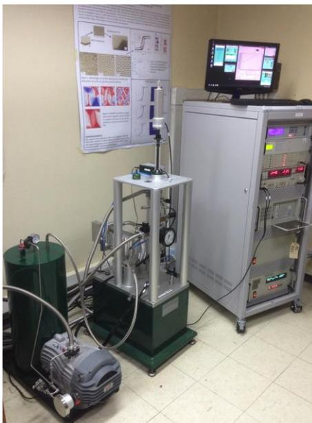
*Figura 2.10 Equipo VSM CRYOGENIC.*
