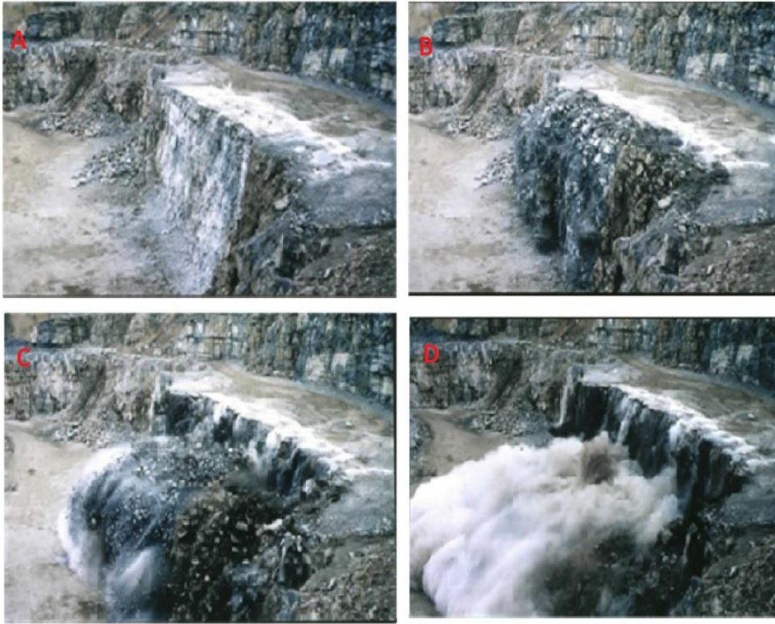
Figura E-7:Fases del proceso de fragmentación de la roca (tronadura real).
