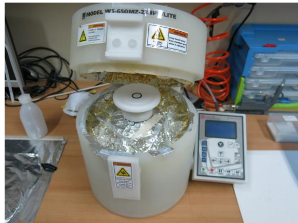
Figura.19- (a) Preparación de la solución de polímero para el recubrimiento de los sustratos. (b) Recubridor de rotación usado para el recubrimiento homogéneo del sustrato con la solución de polímero.
