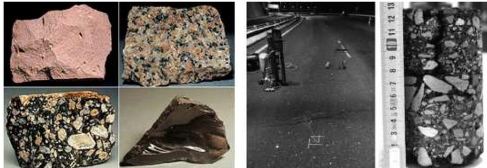
Figura 1.2. Izquierda. Rocas homogéneas y granulares. Derecha. Probeta extraída de asfalto
