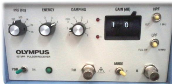
Figura 3.3 Emisor-Receptor de Pulsos Ultrasónicos.
