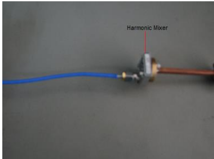
Figura 62: Foto donde se aprecia el cable SMA conectado al mezclador armónico por la izquierda y esté conectado a la guía de cobre por la derecha.
