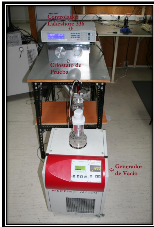
Figura 48: Imagen del criostato, el controlador PID y el generador de vacío en funcionamiento.
