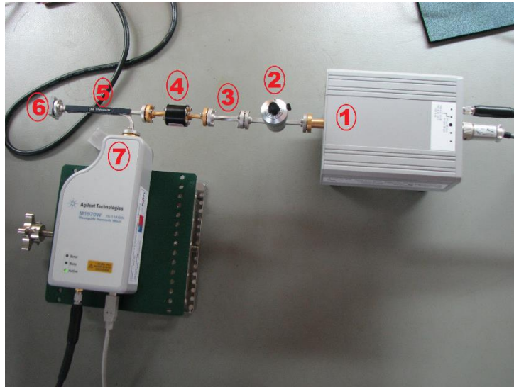
Figura 44: Foto del montaje de calibración con corto, donde '1' es la extensión del generador, '2' atenuador, '3' 'twist', '4' aislador, '5' acoplador direccional, '6' corto y '7' la extensión del analizador.
