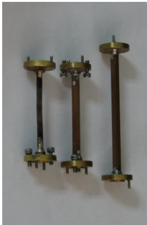
Figura 36: Foto representativa de las guías confeccionadas en el laboratorio mecanico.
