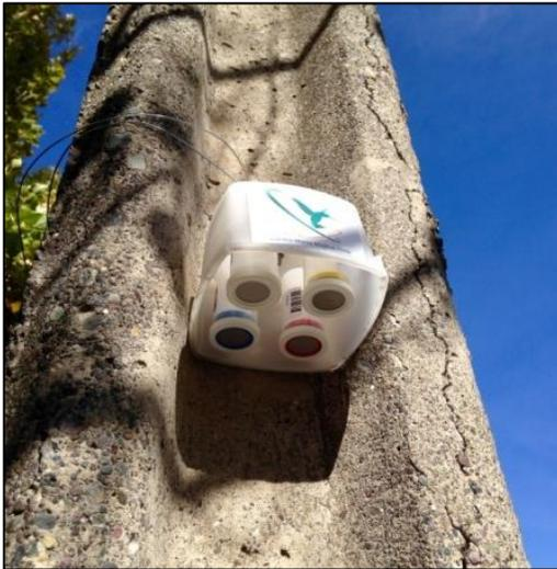
Figura 6.6: Fotografía de 4 tubos pasivos de  $O_3$ ,  $SO_2$ ,  $NO_2$  y  $NH_3$  colocados al interior de un recipiente. Fuente: Elaboración propia.
