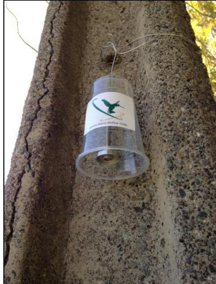
**Figura 6.14:** Fotografía de 1 tubo pasivo de COV's colocado al interior de un vaso plástico desechable. Fuente: Elaboración propia.
