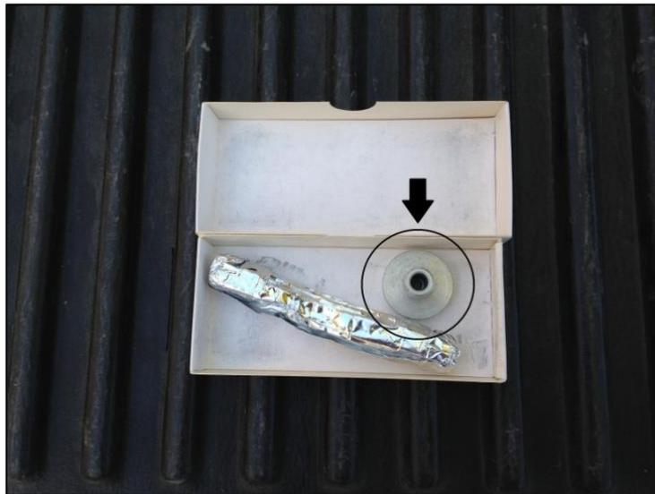
**Figura 6.11: Fotografía de un tubo pasivo de COV's tal cual es recibido del IVL.
