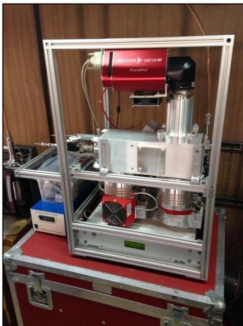
**Figura 9.7:** Fotografía del Monitor de Especiación Química de Aerosoles marca *Aerodyne Research Inc.* al interior de la unidad motora de contaminantes atmosféricos. Fuente: Elaboración propia.
