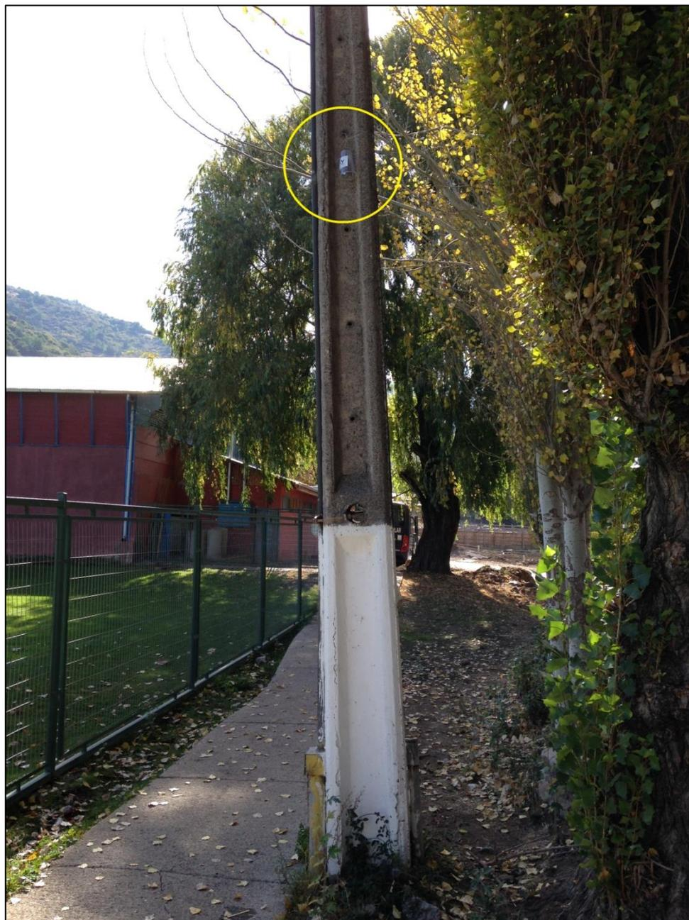
**Figura 6.15: Fotografía de la perspectiva de 1 tubo pasivo de COV's (encerrado en un círculo de color amarillo) colocado al interior de un vaso plástico desechable, instalado a 3 [m] de altura en un poste de luz en el pueblo de Coya, VI región. Fuente: Elaboración propia.**
