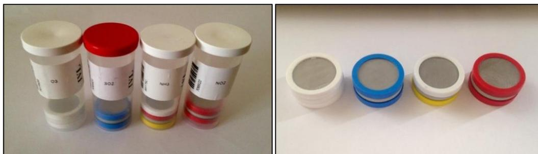
Figura 6.1: A la izquierda, una fotografía de los tubos pasivos de  $O_3$ ,  $SO_2$ ,  $NO_2$  y  $NH_3$  respectivamente. A la derecha, una fotografía de los *muestreadores sensibles* de  $O_3$ ,  $SO_2$ ,  $NO_2$  y  $NH_3$  respectivamente. Fuente: Elaboración propia.
