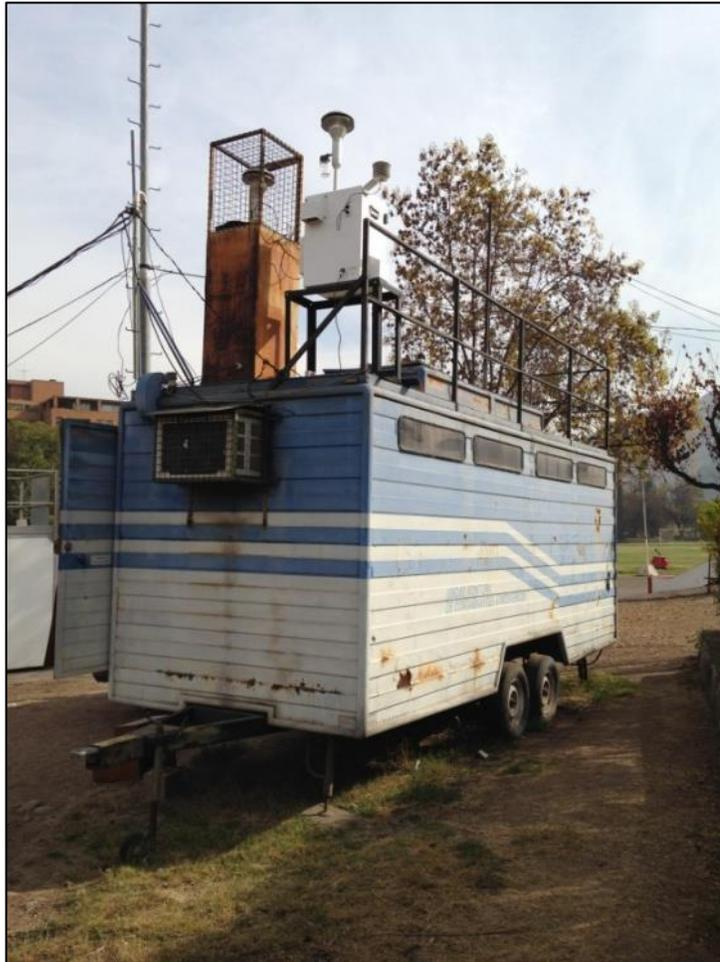
**Figura 9.6: Fotografía de la unidad motora de contaminantes atmosféricos ubicada al costado izquierdo de la estación de monitoreo Las Condes perteneciente a la red SINCA. Fuente: Elaboración propia.**
