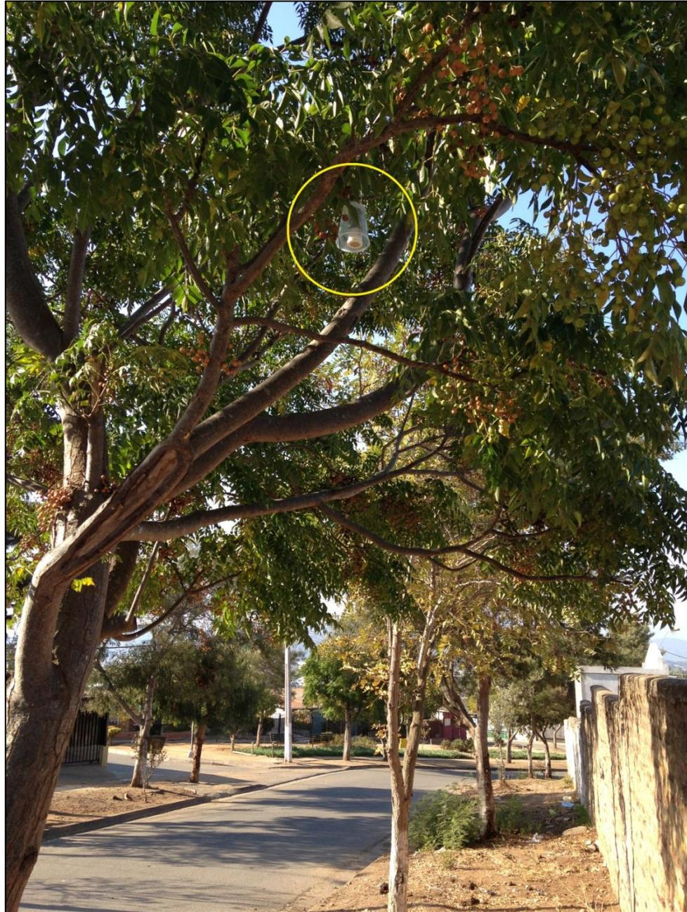
**Figura 6.9:** Fotografía de la perspectiva de 1 tubo pasivo de O<sub>3</sub> (encerrado en un círculo de color amarillo) colocado al interior de un vaso plástico desechable, instalado a 3 [m] de altura en un árbol en el pueblo de Melipilla, RM. Fuente: Elaboración propia.
