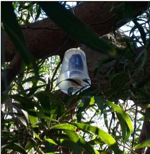
Figura 6.7: Fotografía de 1 tubo pasivo de  $O_3$  colocado al interior de un vaso plástico desechable. Fuente: Elaboración propia.
