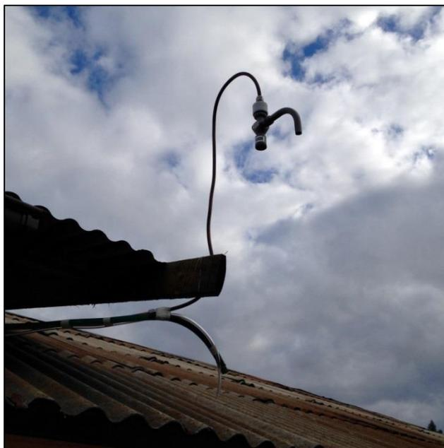
Figura 9.11: Fotografía del *inlet* del Monitor de Especiación Química de Aerosoles marca *Aerodyne Research Inc.* (arriba) y del Etalómetro SIMCA (abajo), ambos instalados en la parte posterior de la bodega. Fuente: Elaboración propia.
