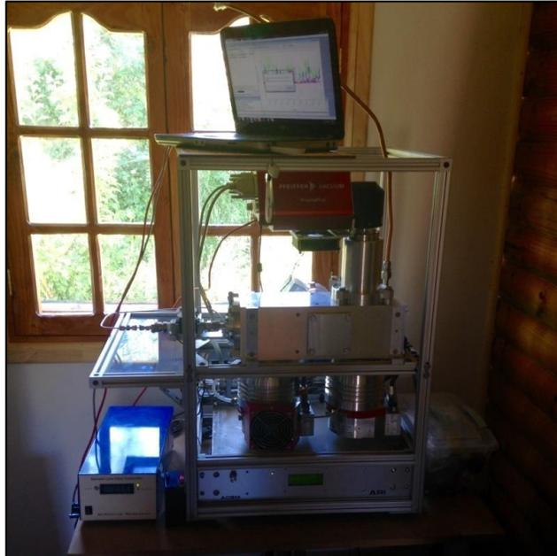
Figura 9.10: Fotografía del Monitor de Especiación Química de Aerosoles marca *Aerodyne Research Inc.* al interior de la bodega de una de las casas principales. Fuente: Elaboración propia.
