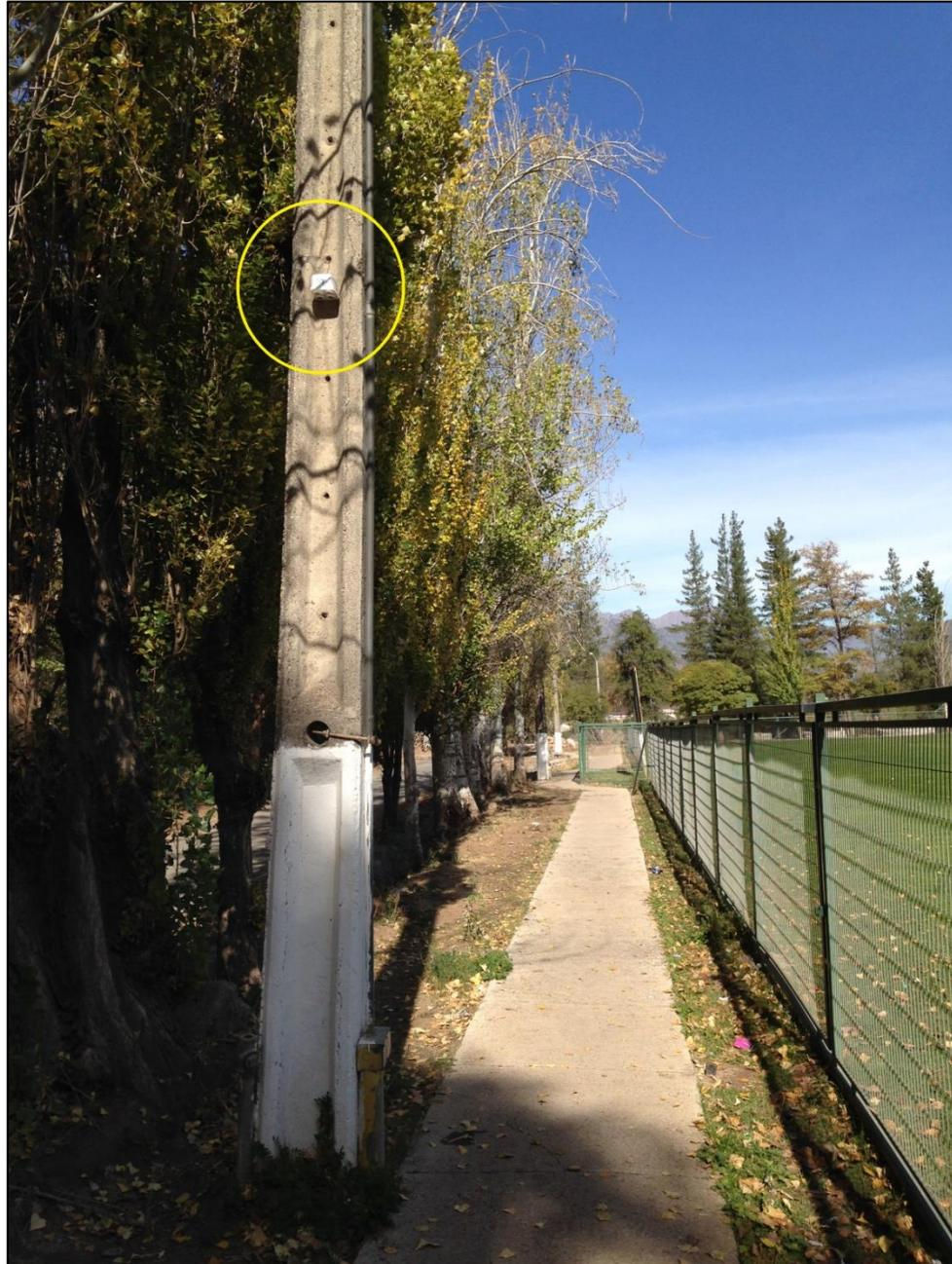
**Figura 6.8: Fotografía de la perspectiva de 4 tubos pasivos (encerrados en un círculo de color amarillo) colocados al interior de un recipiente, instalados a 3 [m] de altura aproximadamente en un poste de luz en el pueblo de Coya, VI región. Fuente: Elaboración propia.**
