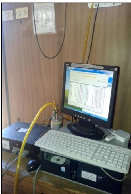
**Figura 9.8:** Fotografía del Etalómetro SIMCA al interior de la unidad motora de contaminantes atmosféricos. Fuente: Elaboración propia.
