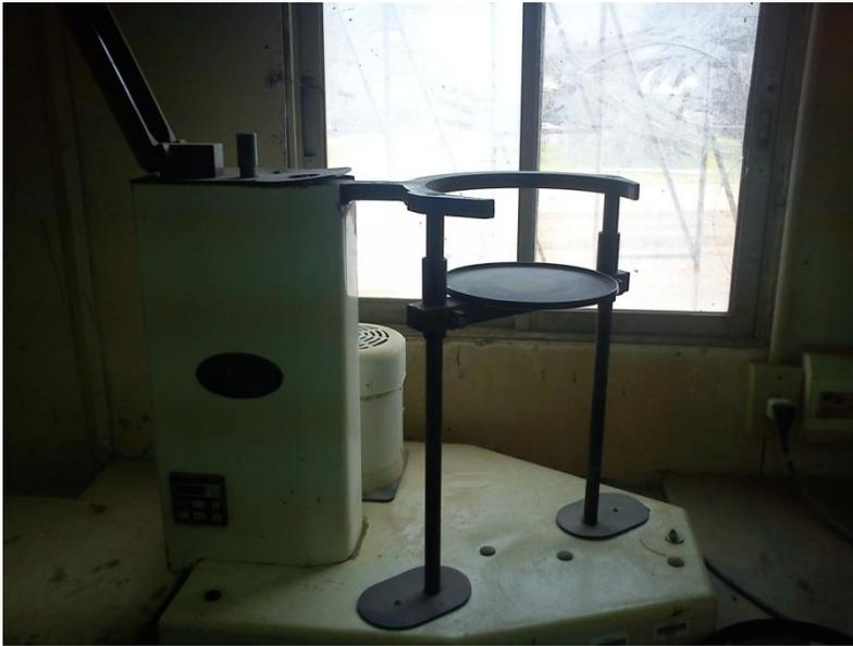
FIGURA 8.2 MÁQUINA DE TAMIZADO UTILIZADO EN TERRENO. MINERA SAN GERÓNIMO.
