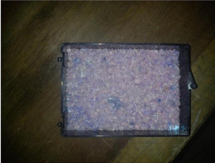
**FIGURA 8.4 MUESTRA DE SILICA GEL QUE YA CONTIENE HUMEDAD ABSORBIDA.**
