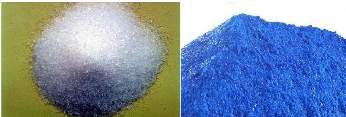
**FIGURA 8.6 MUESTRA DE SULFATO DE COBRE MONOHIDRATADO (IZQUIERDA) Y PENTAHIDRATADO (DERECHA).**
