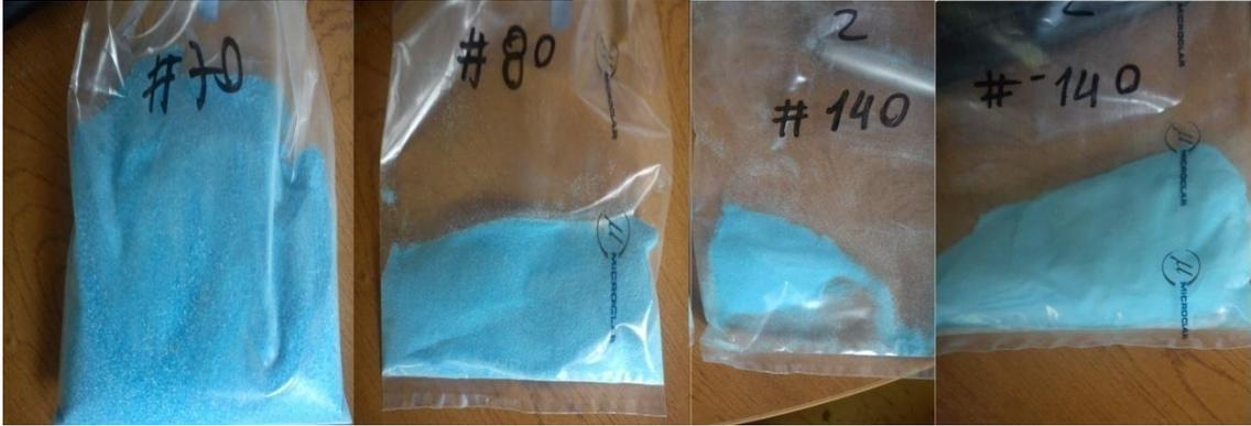
**FIGURA 8.3 MUESTRAS DE SULFATO SEPARADAS SEGÚN TAMAÑO.**
