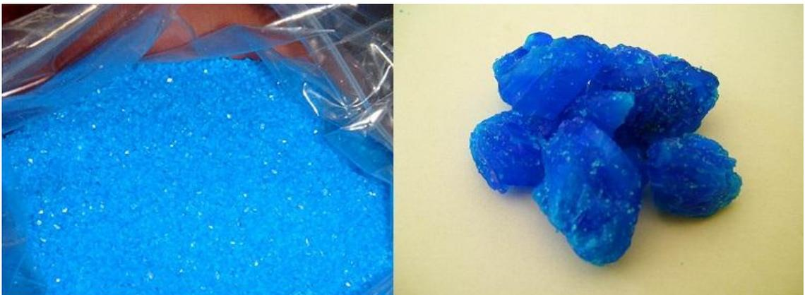
**FIGURA 4 10 MUESTRA DE VENTA Y HÚMEDA RESPECTIVAMENTE DE SULFATO DE COBRE PENTAHIDRATADO.**
