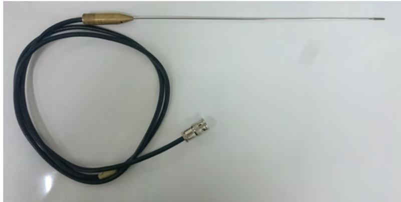
Figura 3.8: La sonda de presión la componen: el elemento activo en la punta, recubierto por una película protectora, varilla de acero de 1.5[mm] de diámetro y 260[mm] de largo sumergible y el cuerpo de bronce donde se conecta el cable de señal.
