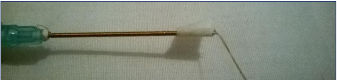
Imagen 4.2-1: Embobinado del hilo de cobre esmaltado en una aguja de jeringa
