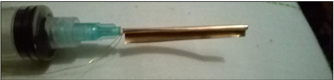
Imagen 4.2-2: Enrollado de casing con placa de cobre
