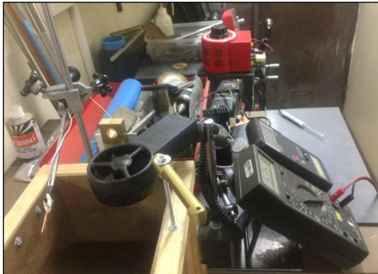
Imagen 4.8-1: Montaje en salida de viento de la turbina con velocidad controlada
