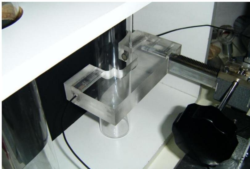
*Figura 3.8. Fotografía del montaje para la caracterización en línea de una emulsión sometida a irradiación ultrasónica.*
