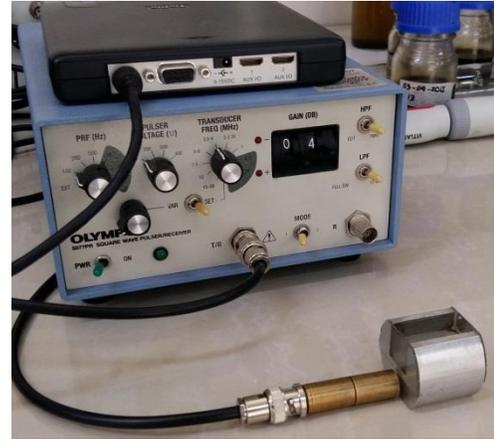
Figura 3.5. Sistema para el análisis de muestras de 7 [m] mediante la determinación de la velocidad de propagación del sonido.
