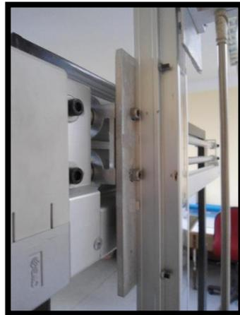
Figura 4-10. Pieza de adaptación de actuadores.
