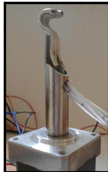
Figura 3-22. Soporte de la Sonda.
