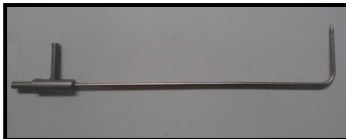
Figura 3-24. Tubo de Pitot empleado en la medición de  $P$  y  $P_S$ .
