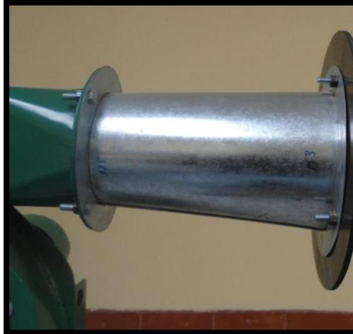
Figura 2-22. Acople ducto de salida con pieza de transformación.
