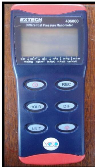
Figura 3-25. Manómetro utilizado para el control de presión en la tobera.
