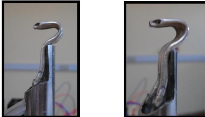
Figura 1-2. Sonda de tres agujeros montado en el laboratorio.
