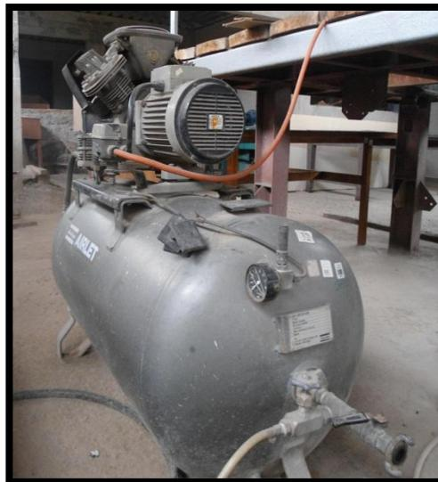
Figura 3-18. Compresor AIRLET, montado en el laboratorio.
