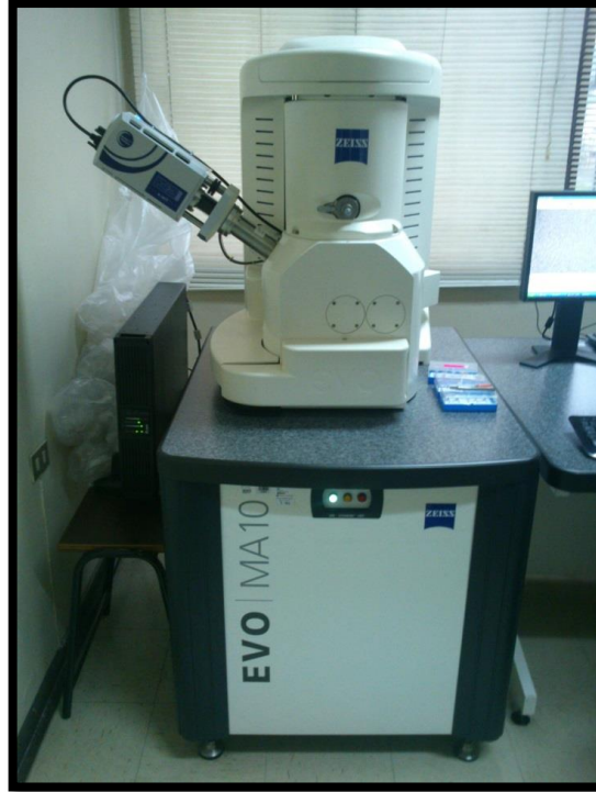
Figura 3-8 Equipo EVO MA10 para microscopía electrónica de barrido (SEM). Además, el equipo cuenta con un detector para EDS incorporado.
