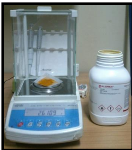
Figura 5-1 Imagen que muestra el pesaje del ferroceno en una balanza de precisión. El polvo de color mostaza es el ferroceno, que luego es introducido a una de las botellas utilizadas para cargar los precursores al reactor.
