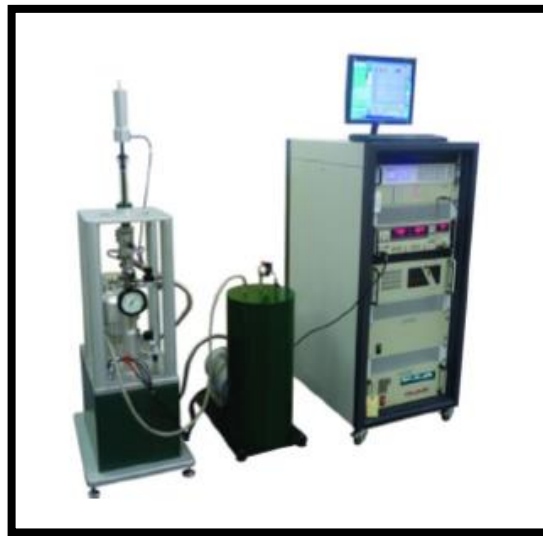
Figura 3-9 Magnetómetro de muestra vibrante (VSM). Imagen referencial, en la práctica se utilizó un equipo que permitía variar el ángulo de aplicación del campo externo respecto a la muestra.
