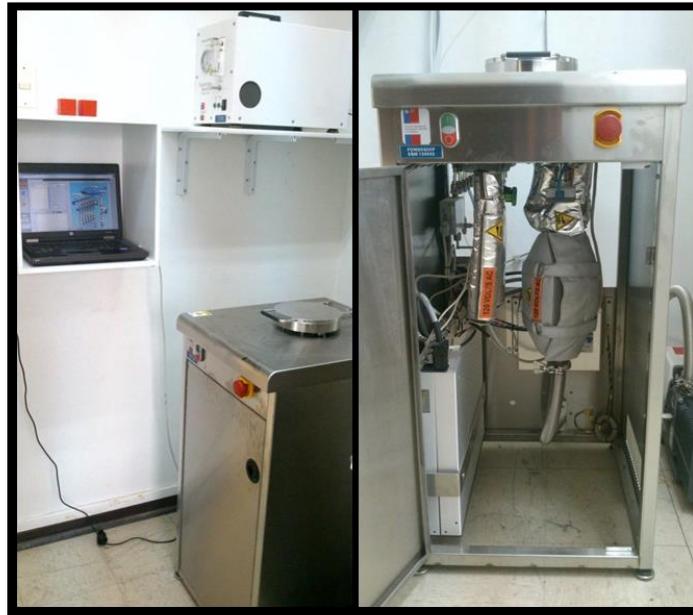
Figura 3-5 La imagen de la izquierda muestra el reactor Savannah S-100, el notebook con el software Labview, y el generador de ozono. La imagen de la derecha muestra el reactor por dentro, donde se observan las envolturas que calientan a los precursores. Además, se observa la caja electrónica (e-box) que monitorea y controla al reactor.
