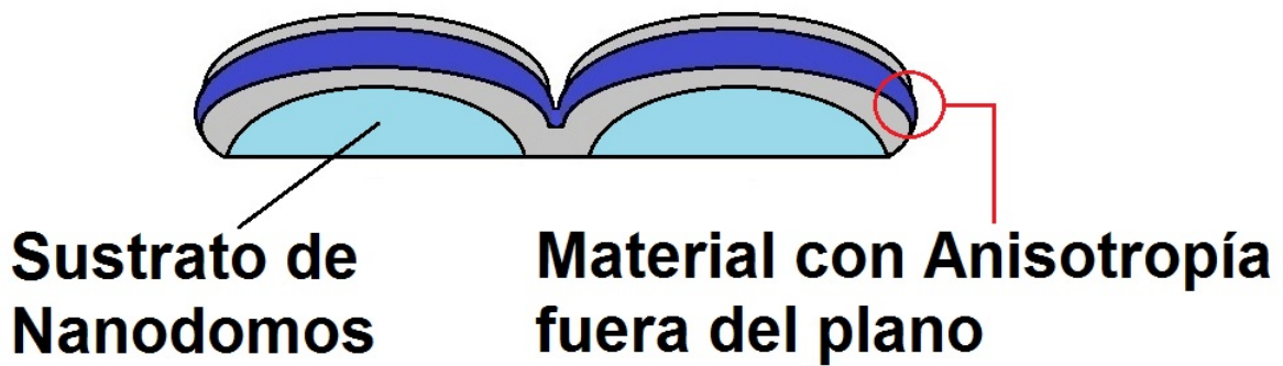
Figura 3.3: Esquema de depósito sobre sustrato de nanodomos. La acumulación de material en la periferia del nanodomo presenta una anisotropía tal que esta apunta fuera del plano de los mismos.
