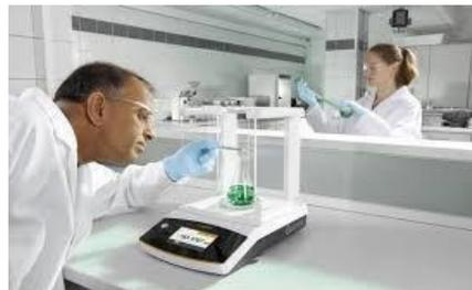
Existen muchos factores que pueden influir en las mediciones realizadas por este tipo de balanza y uno de los más importantes es la nivelación. Estas balanzas incluyen una burbuja de nivel, para poder verificar de forma más expedita la correcta posición del instrumento.
