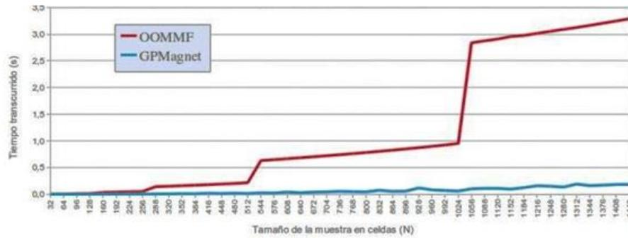
Figura 2.9: Tiempo que demora OOMMF y GPMagnet en avanzar un paso temporal en la simulación de una película de níquel como función del número de elementos.
