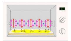
Imagen 1: Patrón de ondas estacionarias generadas en un microondas. Fuente: https://www.thenakedscientists.com/get-naked/experiments/measuring-speed-light
