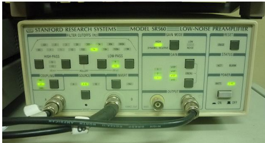
Figura 24. Preamplificador de señales bajas, contiene filtro para bandas de altas y bajas frecuencias, como también permite dar ganancia a la señal. Marca Stanford research system, modelo SR560.
