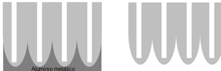
Figura 2.5 (Izquierda) membrana AAO con Al metálico. (Derecha) membrana AAO sin Al metálico.
