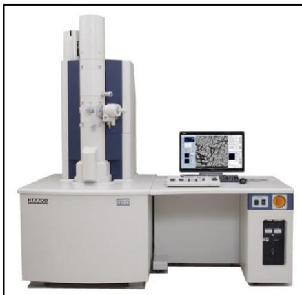
Figura 2.11 Equipo TEM utilizado en la caracterización morfológica y estructural, disponible en Universidad de Santiago de Chile.
