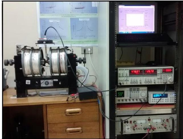
Figura 2.12 Equipo AGFM utilizado para caracterización magnética.
