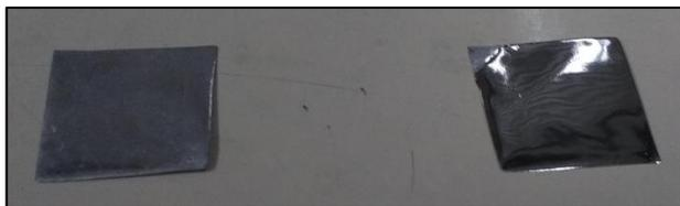
Figura 2.2 (Izquierda) trozo de aluminio sin electropulir. (Derecha) trozo de Aluminio electropulido.
