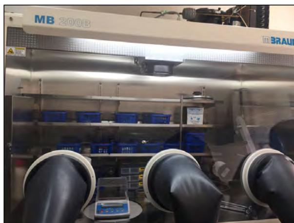
Figura 4.1: Cámara de guantes modelo MB200B marca Mbraun ubicada en el Laboratorio de Nanomagnetismo de la Universidad de Santiago de Chile. La cámara cuenta con una atmósfera de nitrógeno.
