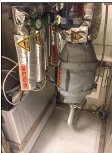
Figura A.5: Interior del reactor Savannah S100 que muestra las botellas con precursor en su interior.
