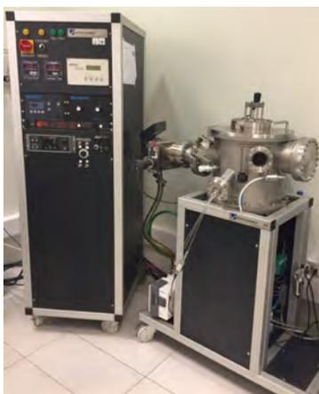
Figura B.1: Equipo de pulverización catódica empleado en el marco de esta tesis.
