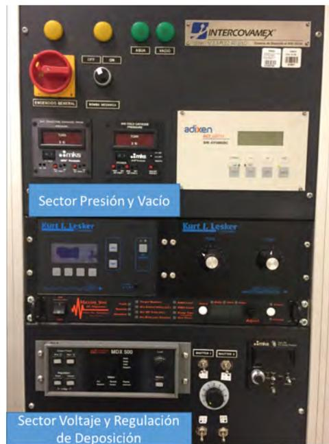
Figura B.3: Sistema de regulación del proceso de sputtering que consta del monitoreo del vacío como también del proceso de deposición.
