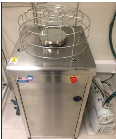
Figura A.1: Equipo de deposición de capas atómicas (ALD) modelo Savannah S100 de la empresa Cambridge-Nanotech.
