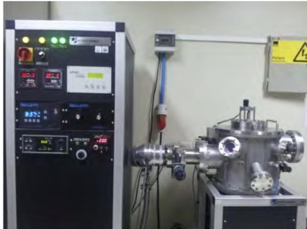
Figura 3.10: Equipo de pulverización catódica ubicado en el Laboratorio de Microscopía Electrónica de la Universidad de Santiago de Chile.
