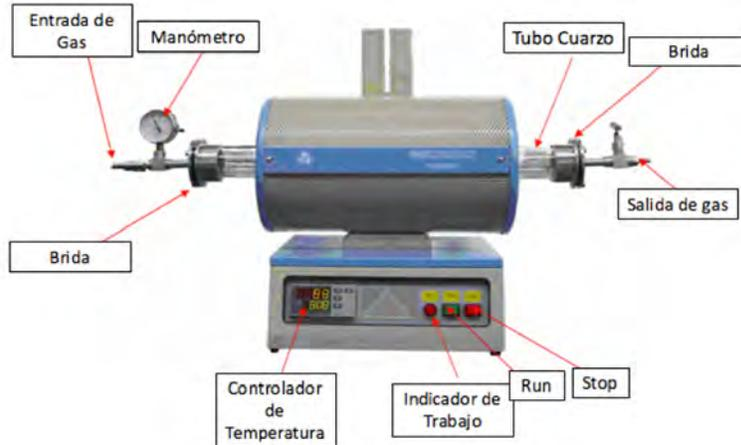
Figura 4.5: Mufla de atmósfera controlada usada para el proceso de reducción térmica. Equipo perteneciente al Laboratorio de Nanomagnetismo de la Universidad de Santiago de Chile.
