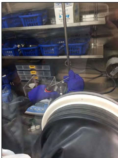
Figura 4.2: Proceso de llenado de una botella con un precursor usando la cámara de guantes.
