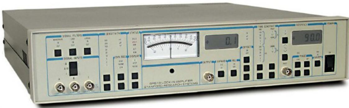
**Figura 19.** Amplificador lockin usado en laboratorio.
