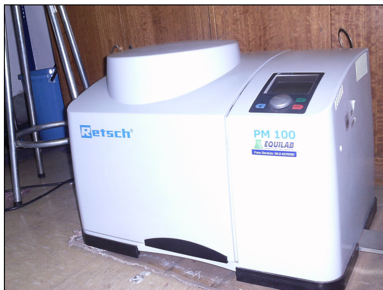
FIGURA 3.2: Molino planetario, del Laboratorio de Aleado Mecánico.
