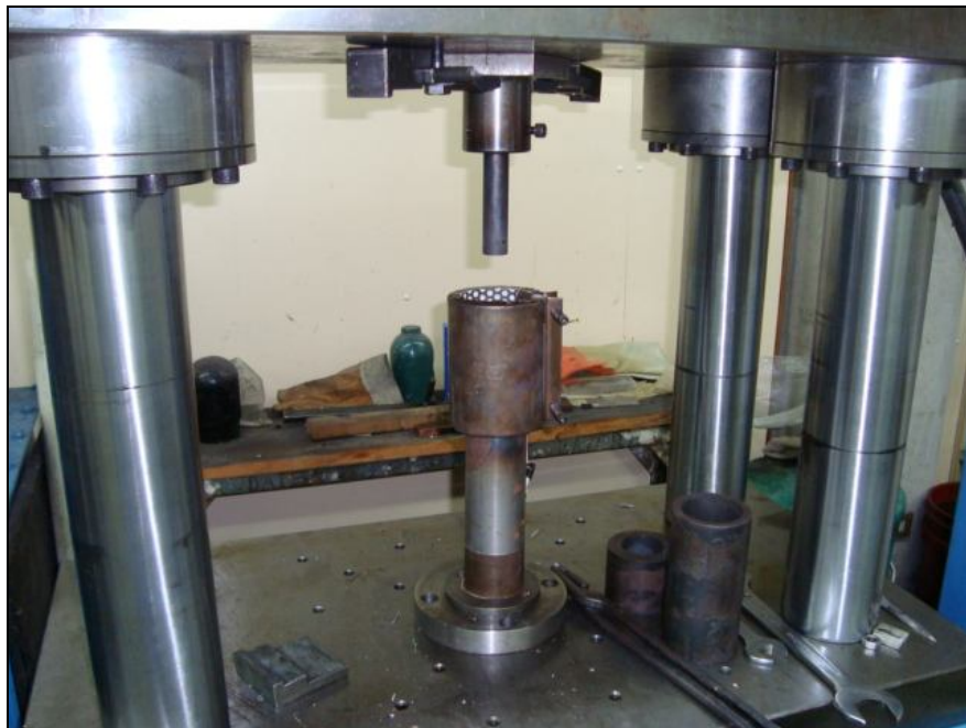
FIGURA 3.3: Montaje prensa, pistón y matriz con el calefactor
