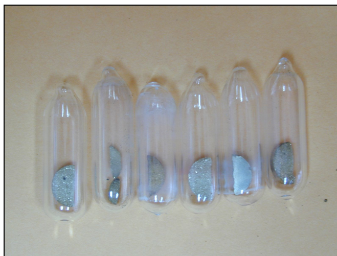
FIGURA 4.5: Muestras prensadas en verde, divididos por la mitad y encapsulados al vacío en tubos de cuarzo.
