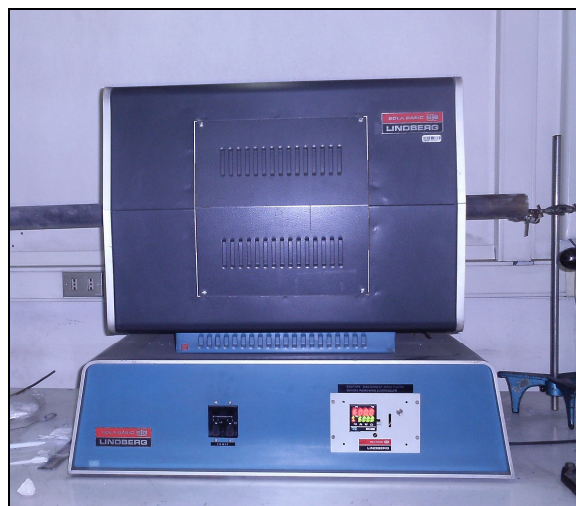
FIGURA 3.7: Horno Lindberg horizontal del Departamento de Física.
