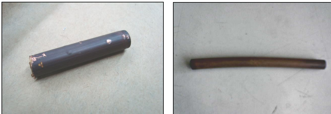
FIGURA 3.4: Barritas recién extruídas y templada en agua.
