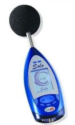
Figura A.1: *Sonómetro 01dB Solo Blue*
