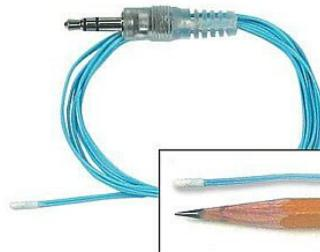
Figura A.3: *Sensor de temperatura de respuesta rápida*
