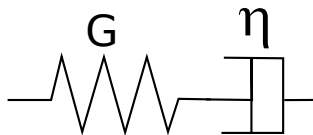
Figura 3.2: Modelo de Maxwell. Resorte de constante elástica G y amortiguador de viscosidad efectiva \eta , La variable f = G/\eta es el parámetro que da cuenta del envejecimiento según el modelo desarrollado en [38].
