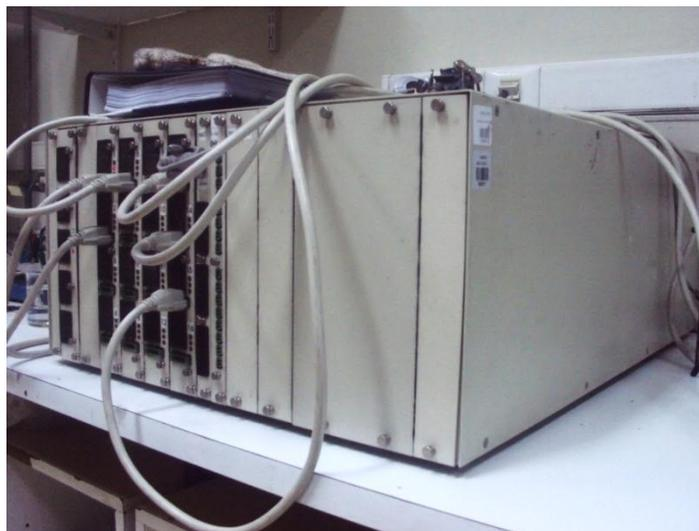
**Figura 6: Galvanostato/Potenciostato multicanal, Arbin Instrument, modelo MSTAT.**
