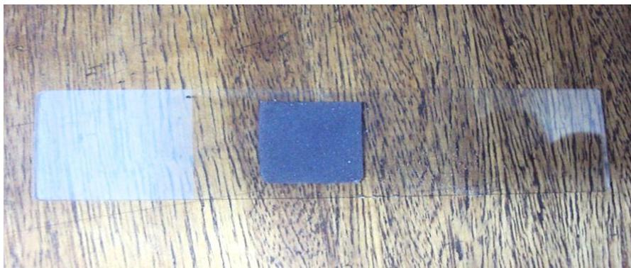
**Figura 8: Muestra preparada para realizar la difracción de rayos X (XRD).**
