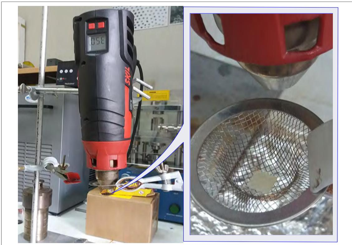
**Figura 6.3.** Montaje para el proceso de Calcinación del fotoánodo.
