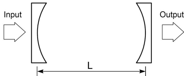
**Figura 11.** Esquema de condición confocal para dos espejos plano cóncavos para la formación de un FPI confocal.
