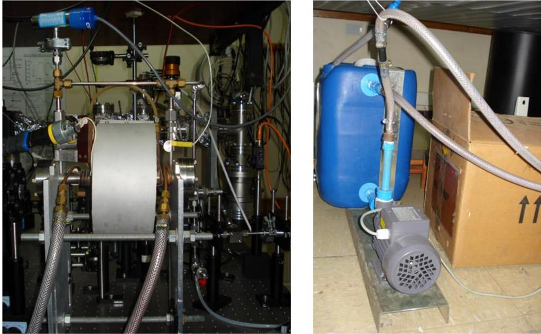
**Figura 52.** Vista real de sistema Heat Pipe terminado. En la figura se aprecia en la imagen de la izquierda, el cuerpo principal del Heat Pipe, el cual muestra la cámara de vacío (tubo de acero con ventanas para alta temperatura) y el horno cerámico que lo cubre en la parte exterior. En la imagen de la derecha se puede apreciar el sistema de enfriamiento terminado y posicionado en el laboratorio.
