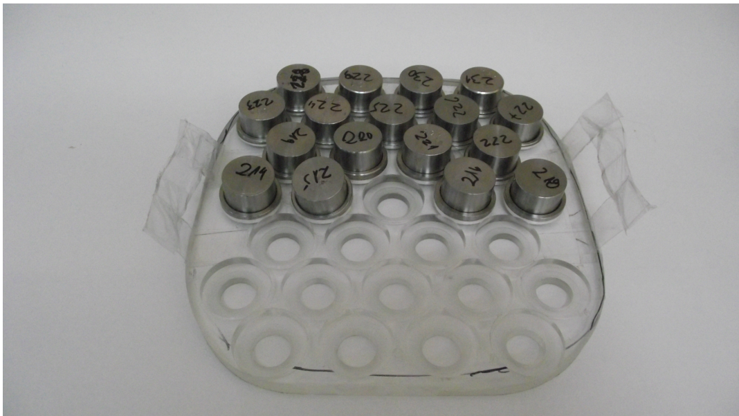
Figura A.3: Montaje de las celdas de difusión con las cutículas para generar el gradiente de concentración de agua debido a la silica gel.
