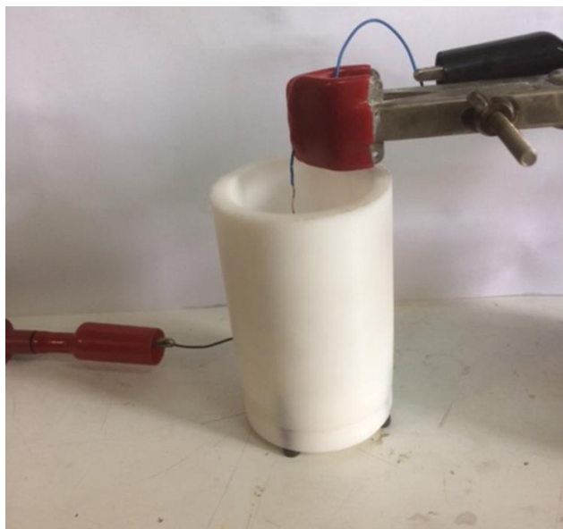
Figura 2.3 Sistema ánodo cátodo para la celda construida.
