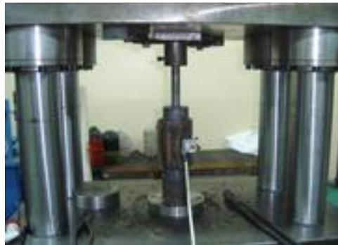
**Figura 3.7** Prensa uniaxial de acción directa de 100 *Ton*.
