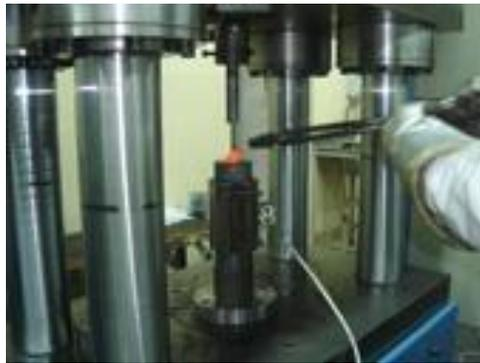
**Figura 3.12** Instante en que se introduce el can al interior de la matriz.
