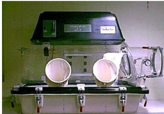
**Figura 3.2** Cámara de guantes Nitrogen Dry Box 850-NB.
