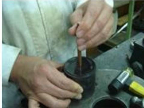
**Figura 3.13** Extracción de la probeta.
