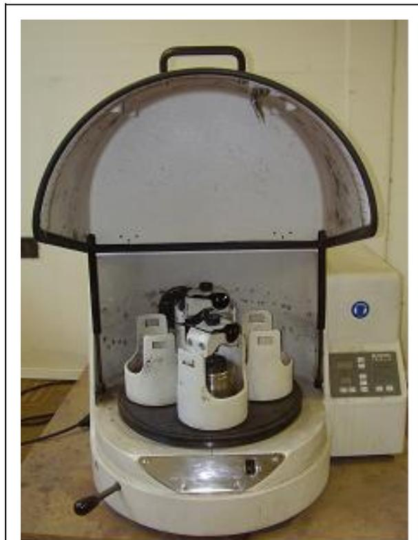
**Figura 3.1** Izquierda, molino planetario Fritsch Pulverisette 5.
