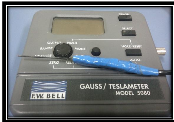
**Figura 3.6: Gauss/teslameter Modelo 5080.**
