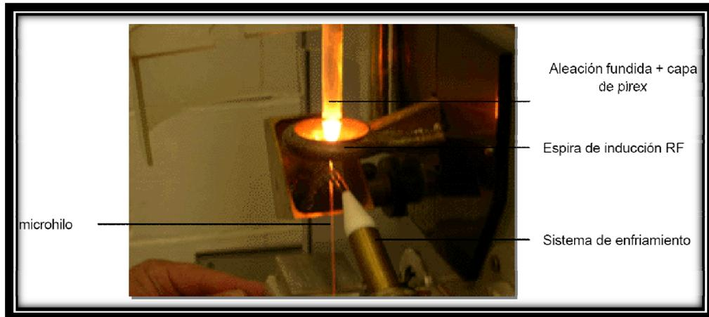
**Figura 3.2: Detalle de la fabricación de microhilos por el método Taylor-Ulitovsky.**
