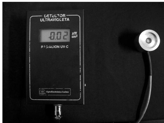
Figura 8.3 Detector UVC, se aprecia el cabezal donde se ubica el fotodiodo, la caja que contiene el sistema electrónico y la pantalla que indica el valor de radiación según su calibración.
