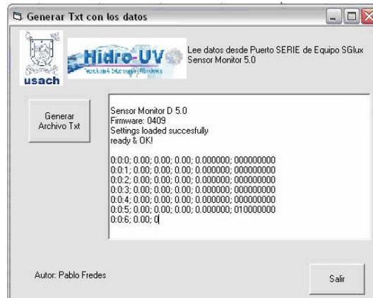
Figura 8.6 Ventana de ejecución del programa desarrollado para captar los datos enviados al puerto Serie por el sistema SENSOR MONITOR 5.0.
