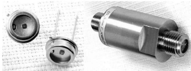
Figura 8.4 Fotodiodo detector de UVC y sistema de encapsulado (Cabezal) para medición en un Reactor Ultravioleta con agua.
