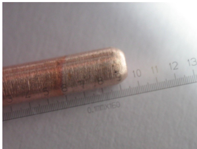
Figura 6.8: Imagen del ánodo, muestra desgaste del material por acción de la lámina de corriente.
