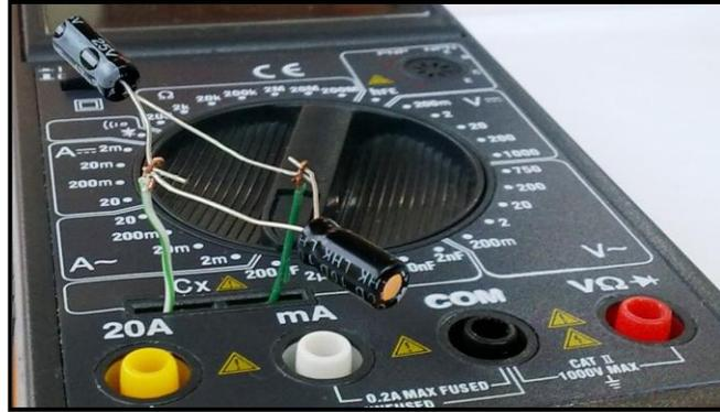
Figura 2.2.2-9: Medición de la capacidad equivalente en paralelo.
