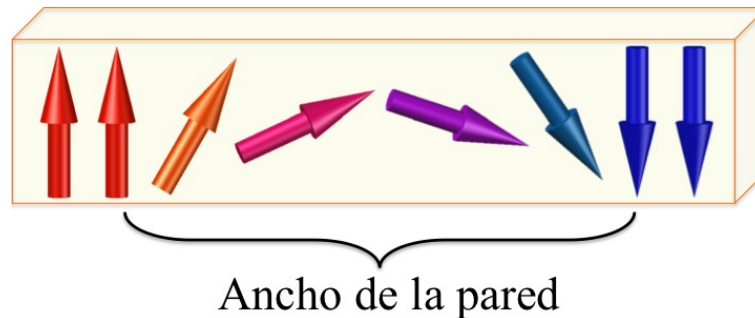
Figura 2.4: Representación esquemática del ancho de una pared de dominio.
