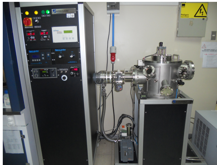
Figura 3.2: Imagen del sistema de depósito de pulverización catódica.
