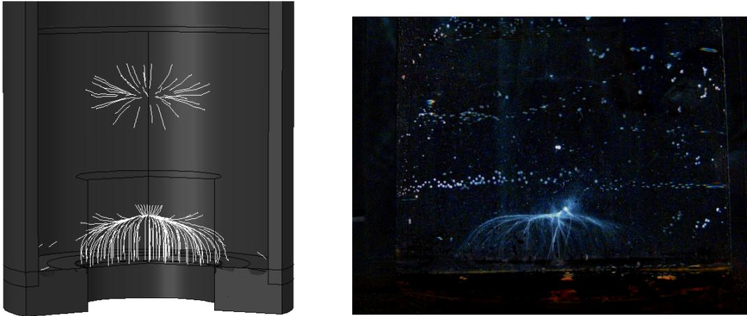
**Figura 2.14:** Comparación de estructuras a bajas presiones experimentales. Al lado izquierdo se muestra la simulación y al lado derecho una imagen del experimento. Si bien parece existir un buen acuerdo entre la forma de las estructuras simuladas con las experimentales, este no es tal, ya que la estructura obtenida por simulación está a niveles de excitación muy superiores a los registrados experimentalmente
