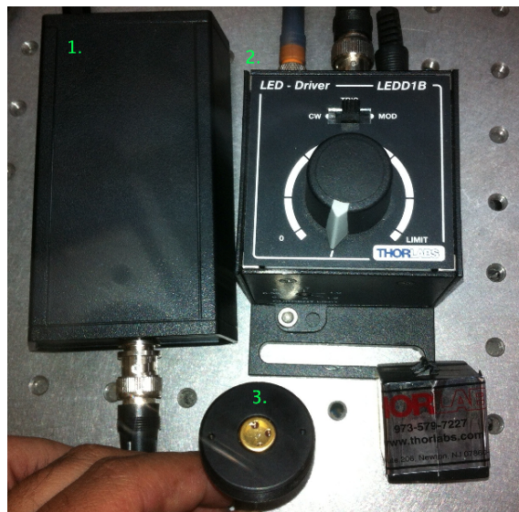
Figura 4.5: 1. Generador de pulsos (1[ms], ciclo de trabajo de 1%); 2. T-Cube Thorlabs®; 3. UV-LED UVTOP con ventana en montura S1LEDM Thorlabs®
