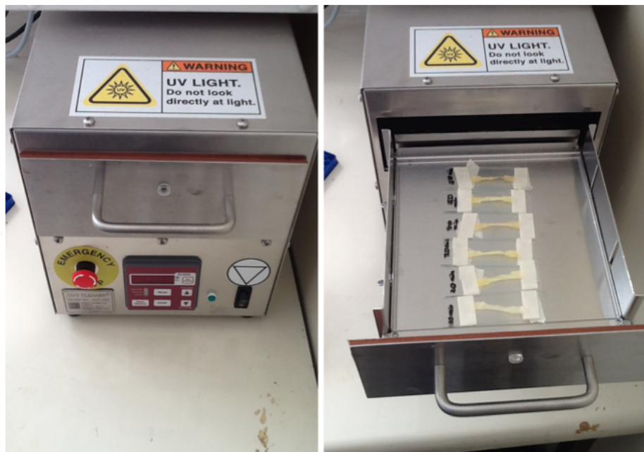
Figura 4.3: Derecha: muestra la maquina de radiación UVO-Cleaner®42. Izquierda: Se muestra las probetas de cutícula dispuestas para la irradiación
