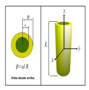
Figura 5.1: Parámetros geométricos de un nanotubo magnético.
