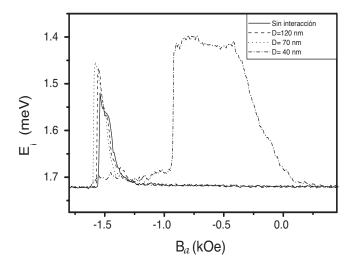
Figura 3.4: Energía dipolar interna del nanohilo central a lo largo de la curva de histéresis. La curvas son para constantes de red D=40 nm, 70 nm, 120 nm e infinito, que corresponde a un nanohilo aislado.
