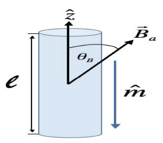
Figura 4.1: Definición de la geometría del sistema. La orientación de la magnetización y del campo magnético corresponden a una condición inicial típica
