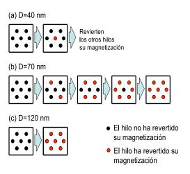
Figura 3.7: Esquema del proceso de reversión de la magnetización para el sistema estudiado. (a) La distancia de separación entre hilos es de 40 nm. Se observa que el primer hilo en revertir es el del centro. (b) La distancia de separación es de 70 nm. Se observa que el ultimo hilo en revertir es el hilo del centro. (c) La distancia de separación es de 120 nm. Se observa que los hilos revierten todos por iguales.
