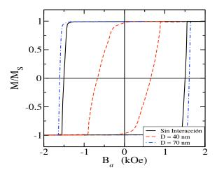
Figura 3.2: Curvas de histéresis para un nanohilo aislado, y para el hilo central de un arreglo hexagonal de siete hilos con constante de red D=40 nm y 70 nm.
