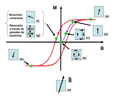
Figura 2.5: Esquema de la reversión de la magnetización a lo largo de la curva de histéresis. Después de saturado, el sistema puede revertir a través de una rotación coherente o por medio de la creación y propagación de paredes de dominio.
