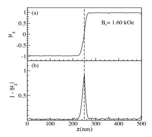
Figura 4.2: Perfil de magnetización típico para  $B_a = 1,6$  kOe: (a)  $\mu_z(z)$  y (b)  $(1 - |\mu_z(z)|)$ . En este caso es fácil identificar la pared de dominio centrada en  $z_w = 250$  nm. La magnetización delante y detrás de la pared es homogénea, y el proceso de reversión puede ser descrito por medio de  $z_w(t)$ .
