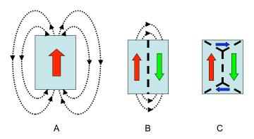
Figura 2.4: Reducción de la energía magnetoestática por medio de la formación de dominios magnéticos.
