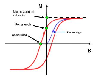
Figura 2.3: Curva de histéresis de un material ferrimagnético o ferromagnético.
