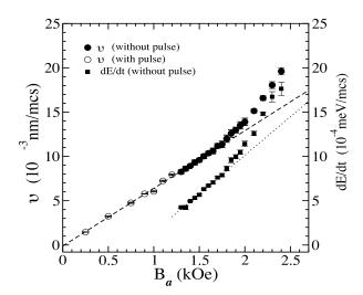
Figura 4.6: Taza de disipación de energía (eje derecho, cuadrados) y velocidad de la pared (eje izquierdo, círculos) como función del campo aplicado. Los símbolos abiertos corresponden a una propagación detonada por un pulso de campo.
