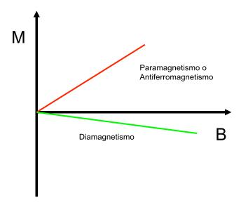
Figura 2.1: Curva de magnetización para materiales paramagnéticos, antiferromagnéticos y diamagnéticos.
