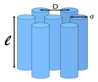
Figura 3.1: Celda que consta de siete hilos, en donde seis forman un hexágono y el séptimo está en el centro. En este trabajo nos focalizamos en el comportamiento del hilo central.
