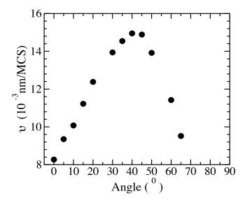
Figura 4.9: Velocidad de propagación de la pared como función de  $\theta_B$  para  $B_a=1,3$  kOe.
