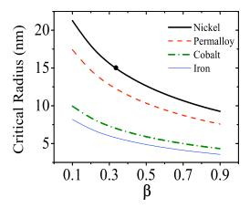
Figura 5.3: Radio critico como función de  $\beta$  para diferentes nanotubos magnéticos [6].
