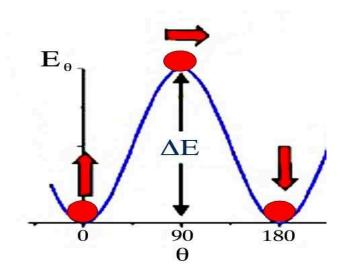
Figura 1.1: Figura esquemática que representa dos estados de igual energía. Para ir de un estado a otro se necesita superar una barrera de energía igual a  $\Delta E = K_a V$ . Si esta barrera de energía es igual a  $k_b T$  o menor, el momento magnético podrá estar en cualquiera de los dos estados y si se toma el promedio temporal de la magnetización dentro de un tiempo, este será igual a cero.
