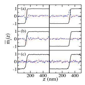
Figura 5.2: Instantáneas de la reversión magnética de tubos definidos por  $\beta = 0.17$  (a), 0,33 (b) y 0,5 (c) en dos etapas diferentes del proceso de reversión. En ellas se muestran los promedios de las componentes de la magnetización en la posición z del tubo.  $\bar{m}_x$ : línea de puntos azul,  $\bar{m}_y$ : línea de trazos roja y  $\bar{m}_z$ : línea sólida negra.
