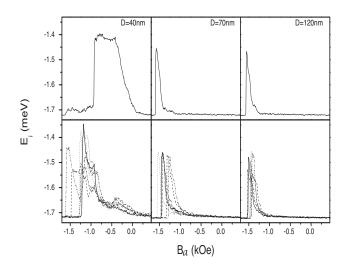
Figura 3.5: Energía dipolar interna de los siete nanohilos a lo largo de la curva de histéresis. En la parte superior se muestra la energía del hilo central, en la inferior la de los seis nanohilos restantes.
