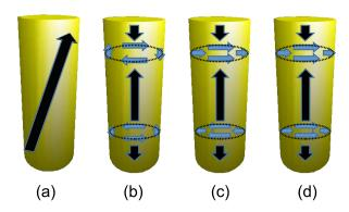
Figura 2.6: Modo de reversión para distintos tipos de hilo. (a) Modo coherente, el que ocurre por lo general cuando el diámetro de la partícula es comparado con el largo del hilo. (b) Modo curling o vortice, con paredes del tipo vórtice. (c) Modo corkscrew, en el que las paredes transversales giran en torno al eje del hilo. (d) Modo transversal, en el que las paredes estan sobre un plano fijo definido por la dirección del campo aplicado y el eje del nanohilo.
