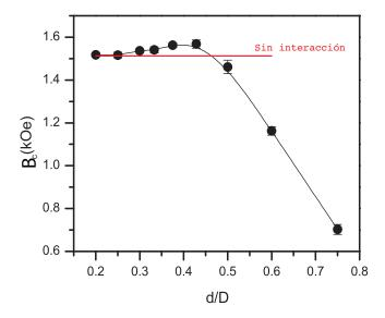
Figura 3.3: Coercividad del nanohilo central en función de la constante de la red. Los hilos tienen diámetro 30 nm y longitud 1000 nm. La línea sólida es una guía
