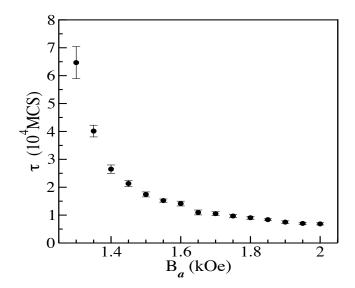
Figura 4.4: Tiempos de espera para diferentes valores del campo aplicado, con  $\theta_B = 0^{\circ}$ .
