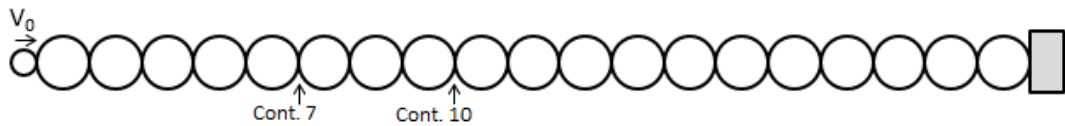
Figura 1.3: Sistema compuesto de 20 esferas de acero con un extremo fijo y otro extremo libre donde la primera esfera de 8 (mm) de diámetro impacta a las demás esferas con una velocidad ( V_0 ).
